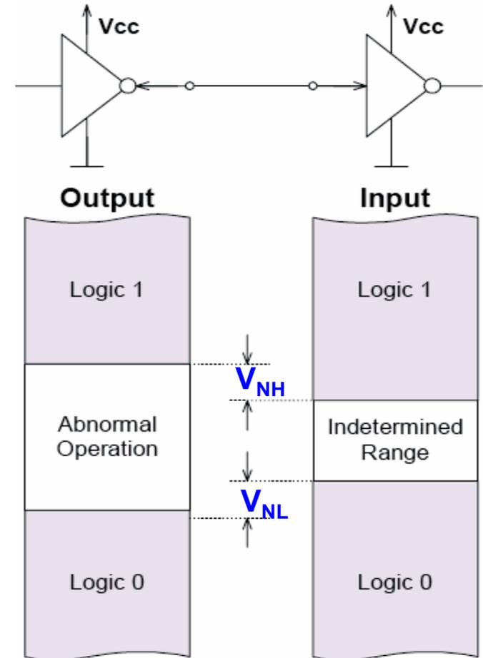
$$V_{NH} = V_{OH(\min)} - V_{IH(\min)}$$
